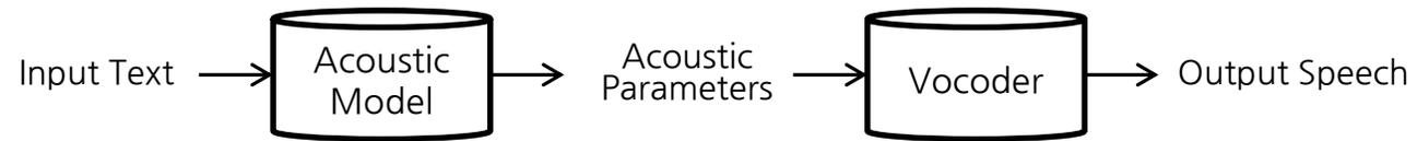
딥러닝 TTS 기술은 크게 acoustic model 과 vocoding model 두가지 모듈로 구성됩니다
